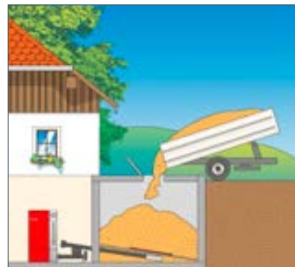
Houtsnipperopslag in aangebouwde bunker met grote opening voor hervulling.
