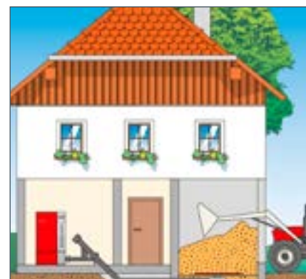
Tussen houtsnipperopslag en stookruimte een inlooppassage/gang (hellende vijzel)
