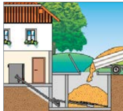
Houtsnipperopslag in aangebouwde bunker en verbindingsvijzel voor transport naar hogere verdieping.
