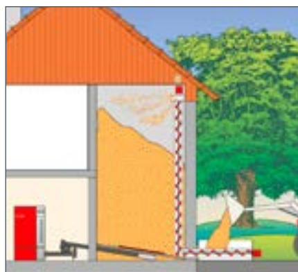
Grote houtsnipperopslag op het gelijkvloers met verticale vulvijzel.
