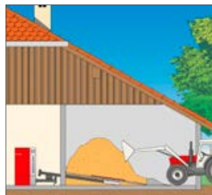
Grote open houtsnipperopslag op het gelijkvloers met directe vulmogelijkheid.
